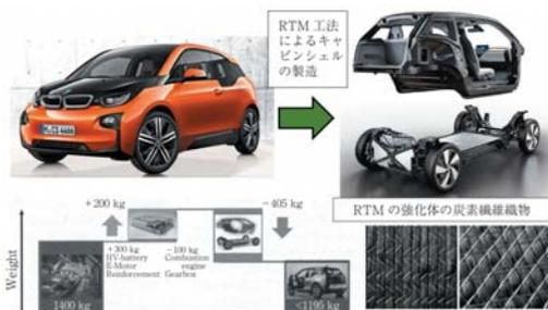
世界初のCFRP量産電気自動車 (BMW i3)
