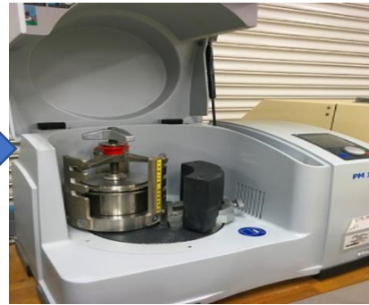
遊星ボールミル粉碎→選択的メカノケミカル反応
